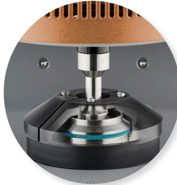
Agregue una **Trampa de Solvente Aislada (Insulated Solvent Trap)** para evitar el secado durante las mediciones. Las dos cubiertas divididas se integran con geometrías compatibles a fin de crear una barrera contra la evaporación. El interior conductor y el exterior aislante promueven la uniformidad de la temperatura a temperaturas extendidas.
