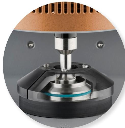
測定中の乾燥を防ぐため、**絶縁溶媒トラップ**を追加することができます。2つの分割カバーは、互換性のある形状と統合して蒸発バリアを形成します。内部の導電性と外部の絶縁性により、幅広い温度にわたって温度の均一性が促進されます。
