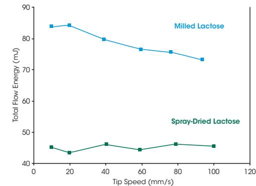
乳糖は医薬品賦形剤として広く使用されていますが、加工性は粒子の形態に大きく依存します。噴霧乾燥された乳糖の滑らかな球形の粒子とは異なり、粉碎された乳糖のギザギザで不規則な粒子は、絡み合って流れを阻害する傾向があります。流動性の測定により、粉碎乳糖の流動抵抗が低速で増加することが明らかになり、分注または金型充填時の材料の動きが遅いことが予測されます。この知見により、噴霧乾燥乳糖はコストのかかる製造上の問題を回避し、製品の品質を確保するための理想的な賦形剤であることがわかりました。
