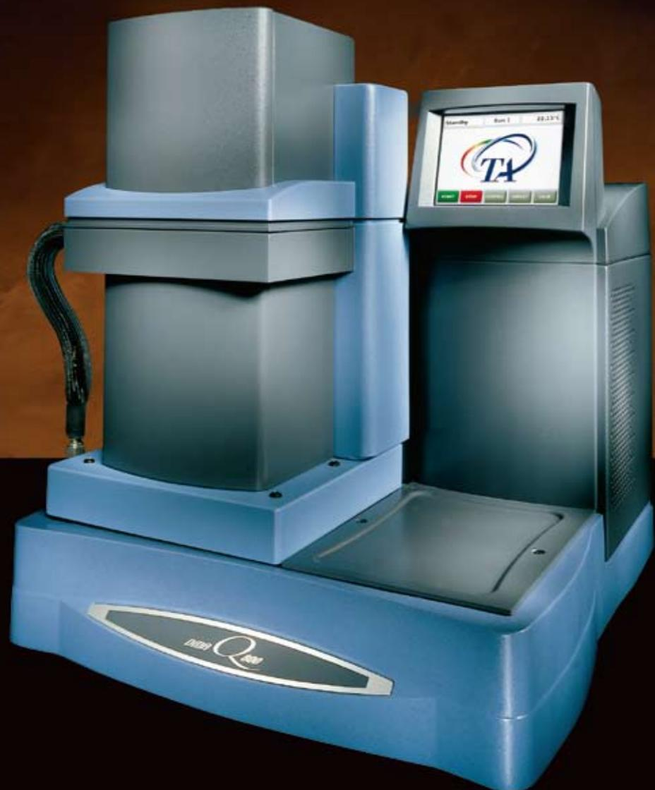
Q800是全球最为畅销的DMA仪器，能为各种应用提供最完美的解决方案。它采用顶尖技术的非接触式线性马达施加应力，空气轴承确保低摩擦支持。应变的测量是通过光学编码器，实现无可比拟的灵敏度和分辨率。如此独一无二的设计，使得Q800轻而易举地超越同类竞争产品，对于高刚性材料(复合材料)的应用实验也是得心应手。
