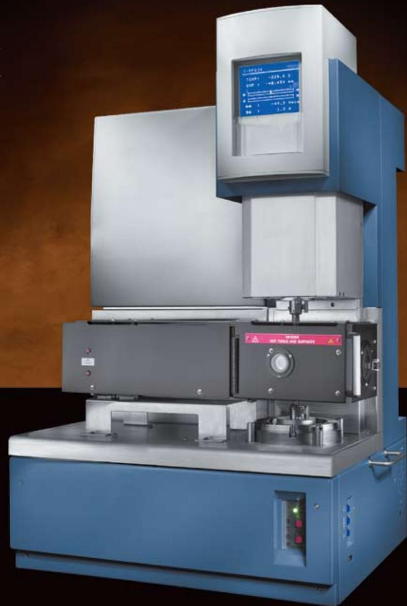
RSA III为高性能的DMA测试提供了强大的操作平台。它采用先进的直接驱动线性马达施加应变，并且采用专利的力值再平衡传感器™测量应力；低摩擦的空气轴承保证了最佳的灵敏度。RSA III 特别适用于软材料的压缩测试，例如凝胶和弹性体，或对于低刚度薄膜和纤维的高频测量。
